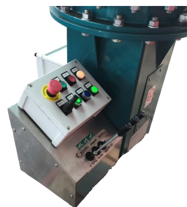
Las palancas de control hidráulico y los mandos
